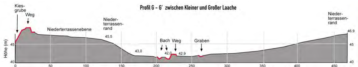
Abb. 4.3.4-2: Querprofil durch den holozänen Rheinarm zwischen Kleiner und Großer Laache (anthropogene Formen in rot)
