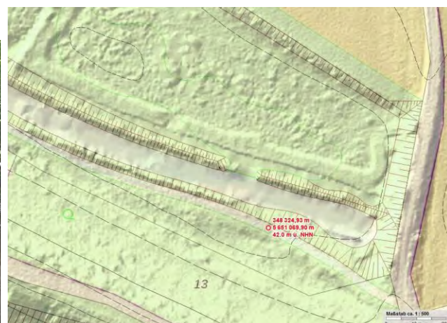
Abb. 4.7-10: Ermittlung der Überflutungshöhe durch geschummertes DGM, Isohypsen und Höhenpunkt-Einmessung (Quelle: www.tim-online.nrw.de Zugriff 21. Januar 2025)
