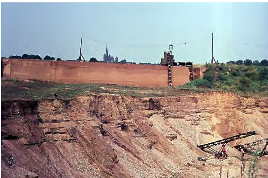
Abbildung 2-5: Löss über Mittelterrassen-Rheinschottern; ehemalige Ziegelei- und Sandgrube der Arbeitsanstalt Brauweiler (SCHREINER 1970)
